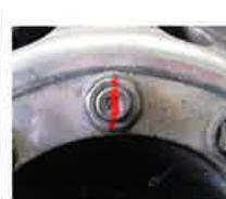
締付け後は初期なじみによってホイールナットの締付け力が低下します。
